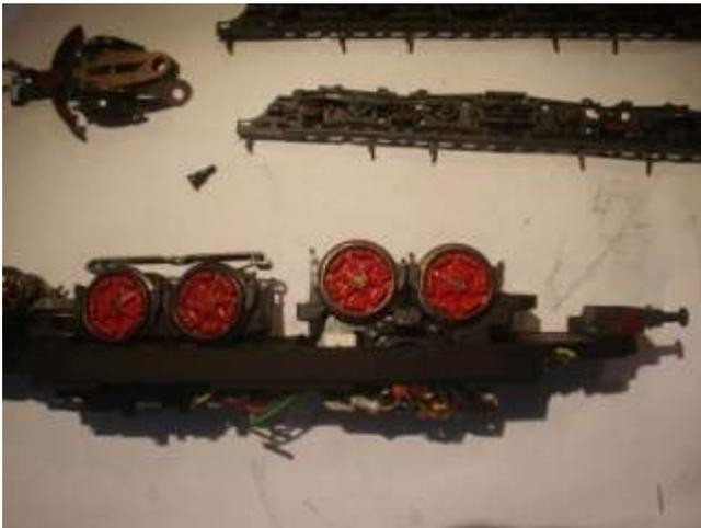
Per il 236 il motore è subito accessibile , per la 19 occorre sfilare le due fiancate che bloccano le alette del monoblocco motore e poi lui uscirà dalla sede dal di sotto.
