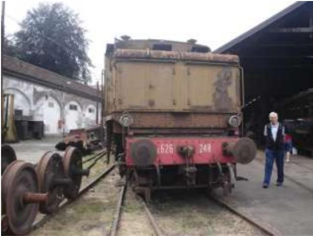
Il 626 è sprovvisto di pantografi.....tanto la line aerea è stata eliminata , sul piazzale si intravedono ancora alcuni pali tubolari della vecchia TE.
