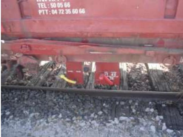
Sono riprese le due piastre che indicano il tipo di freno e la potenza frenate del carro.
