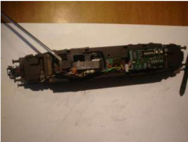
Queste operazioni valgono per tutti i modelli con motore a rotore da 3 o 5 poli , sono alquanto semplice , il più è farlo la prima volta e così individuare da subito come sono sistemati i componeti , alcuni modelli sono a prima vista , incasinati dai vari cavetti dell'impianto luce , creano difficoltà nel loro spostamento , le saldature sono solide e pertanto si può agire liberamente.
