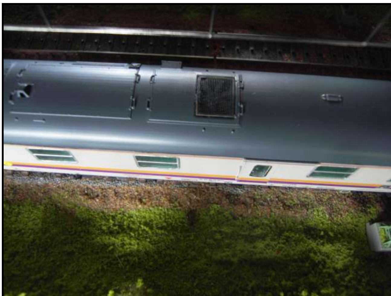
Foto n. 8: Carro nVDrec, particolare del tetto con griglia traforata.
