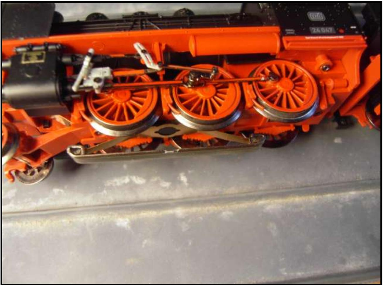
**Foto n. 19: si verniciano i centri delle ruote con rosso acceso**
