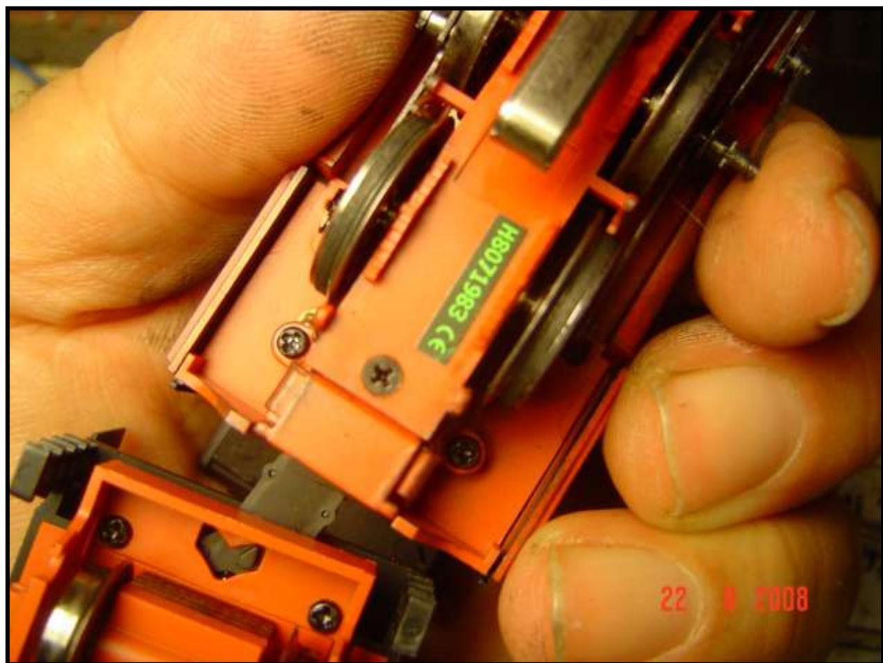
**Foto n. 24: NON SVITATE assolutamente le 3 viti vicine al tender, una trasmette anche il contatto, rivedi anche la foto n. 18!**
