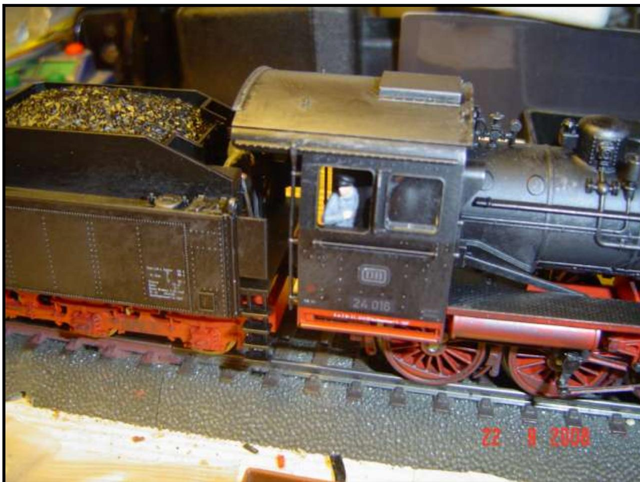
**Foto n. 13: corrimano e scalette fini e robusti della cabina, accostato il tender.**
