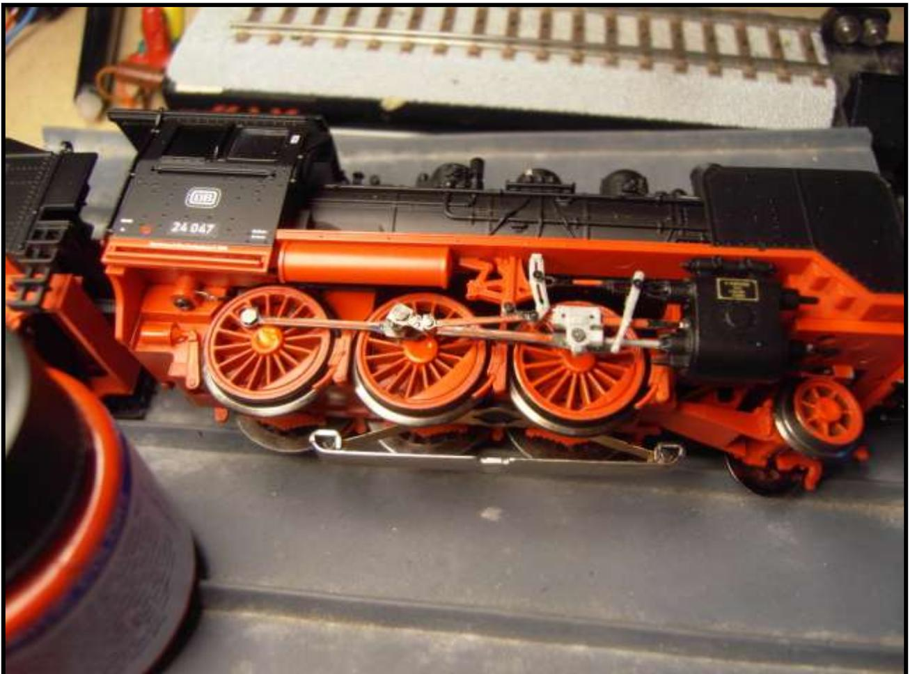
**Foto n. 18: si verniciano i centri delle ruote con rosso acceso; notare il filo del brutto contatto elettrico, proprio sotto la targa della locomotiva.**
