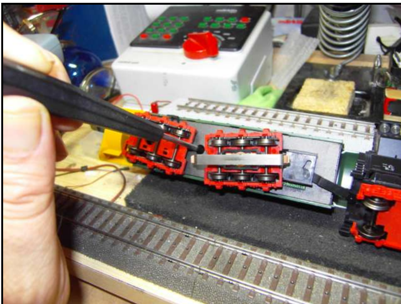
Foto n. 10: una sola vite da allentare per separare il mantello dello sgombraneve.
