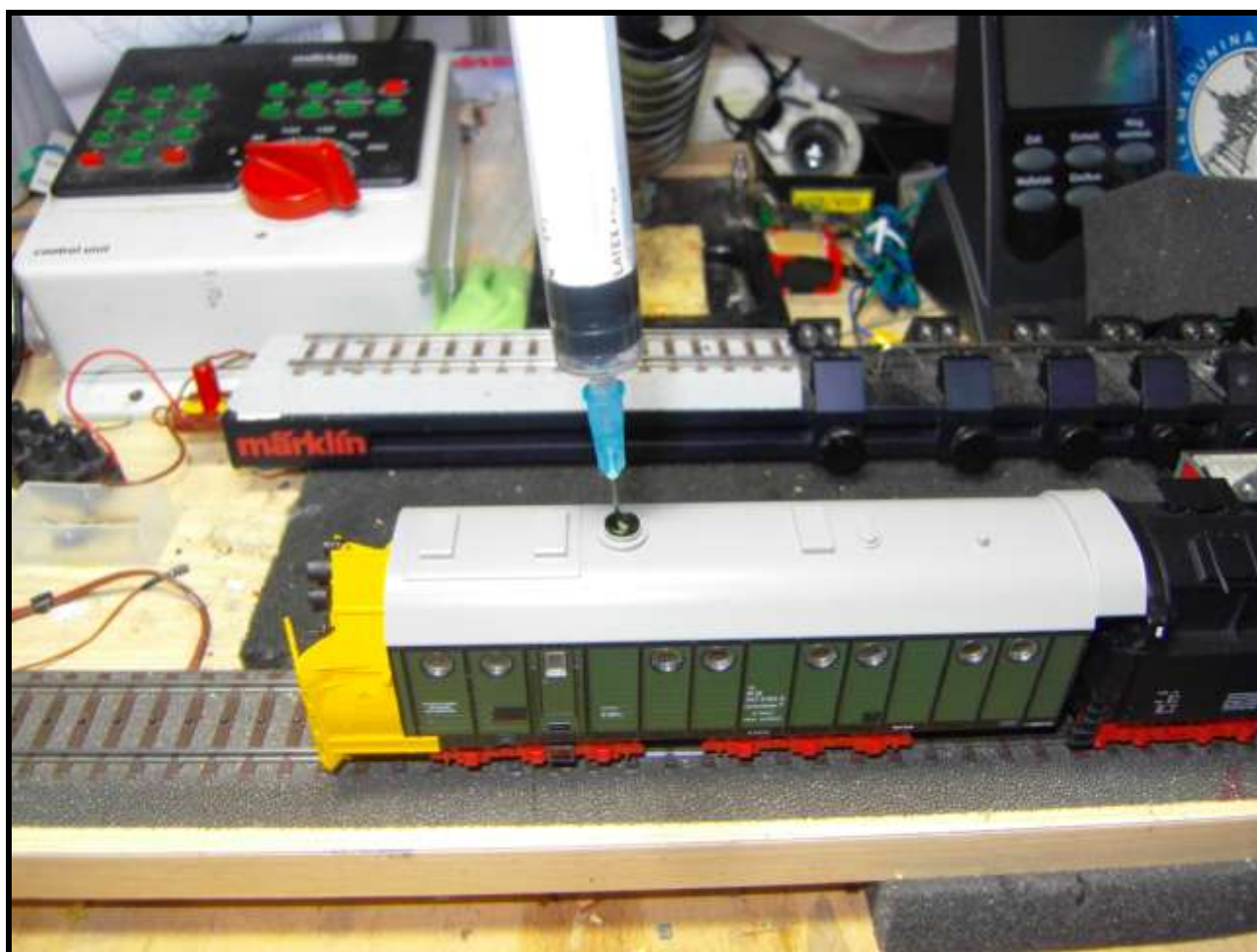
Foto n. 15: con una siringa si provvede a caricare il dispositivo fumo.
