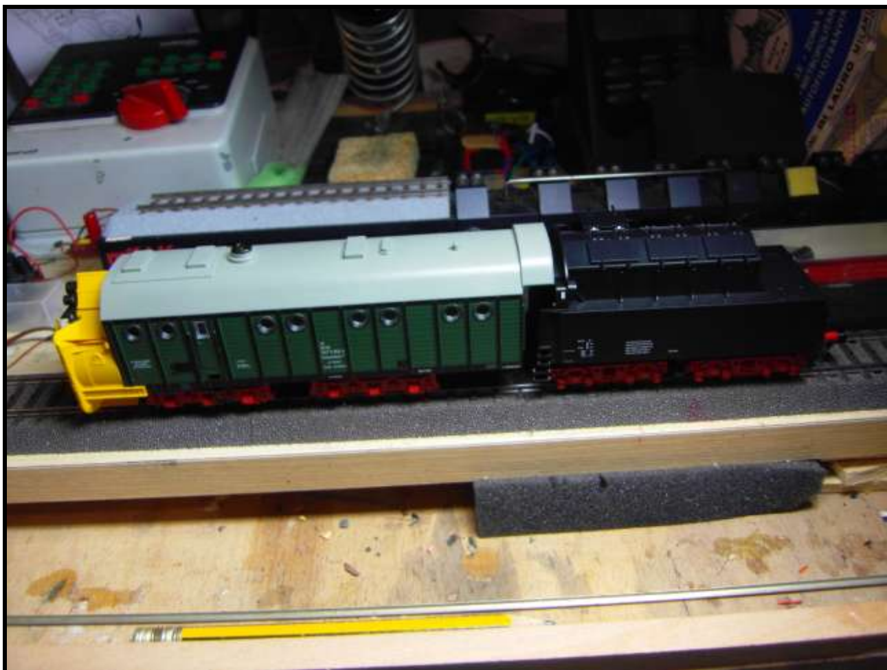
Foto n. 7: aggancio in posizione corta tra tender e spazzaneve, resta comunque un certo spazio tra i due carri inesistente al vero.
