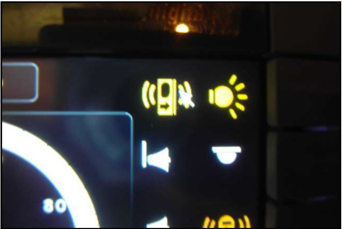
Foto n. 5: foto ravvicinata del simbolo di annuncio di stazione, subito sotto quello della chiusura delle porte, che non appare senza l'ultimo aggiornamento.
