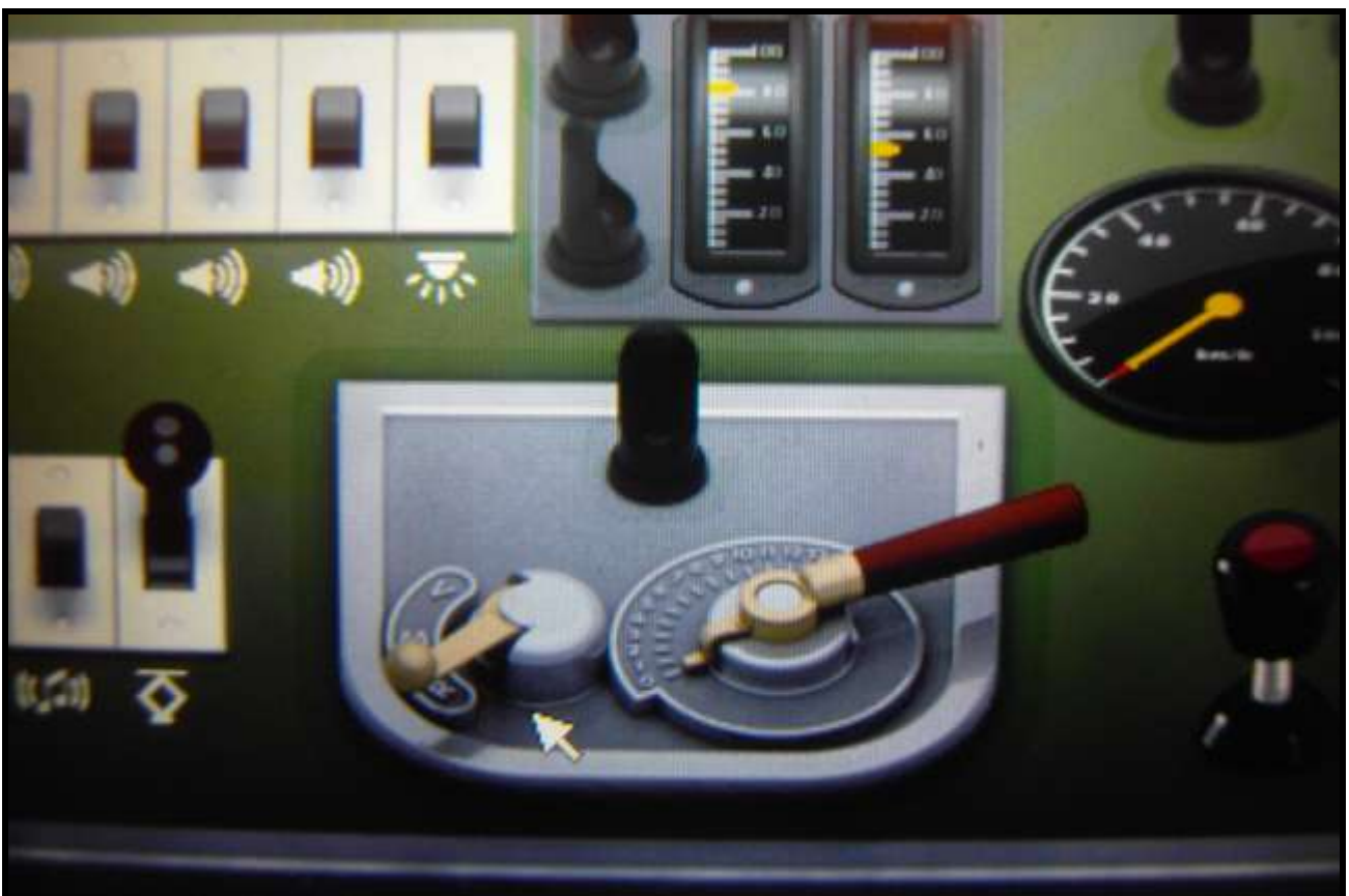
Foto n. 7: l'inversione di marcia si può effettuare con la cabina virtuale solo manovrando, da fermo, e posizionando con lo stilo su V o R la leva indicata dalla freccia del mouse, notate la nuova posizione (a destra) del pulsante SiFa.
