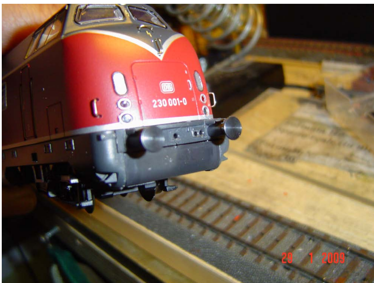
Foto n. 30: carenatura chiusa applicata e fori da ripassare con punta da 1 mm
