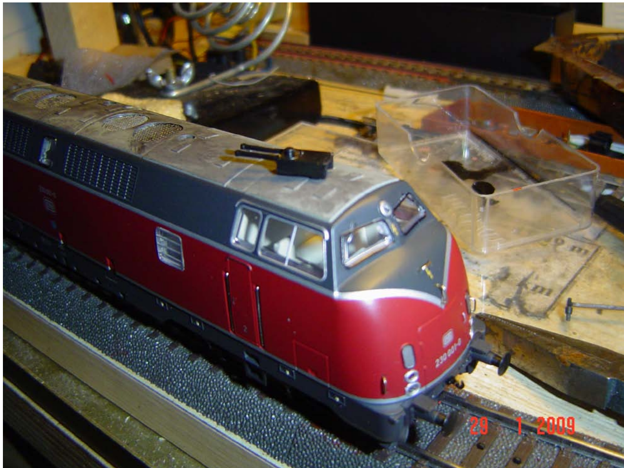
Foto n. 29: il porta gancio da allontanare per poter inserire la carenatura chiusa
