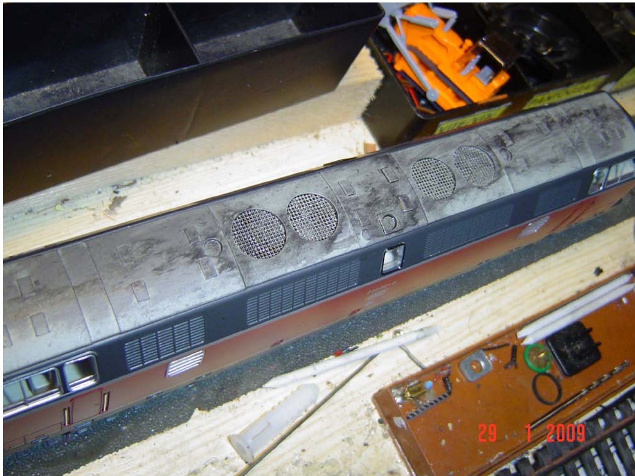
Foto n. 22: il tetto della 230 Märklin, si procede per gradi a sporcarlo
