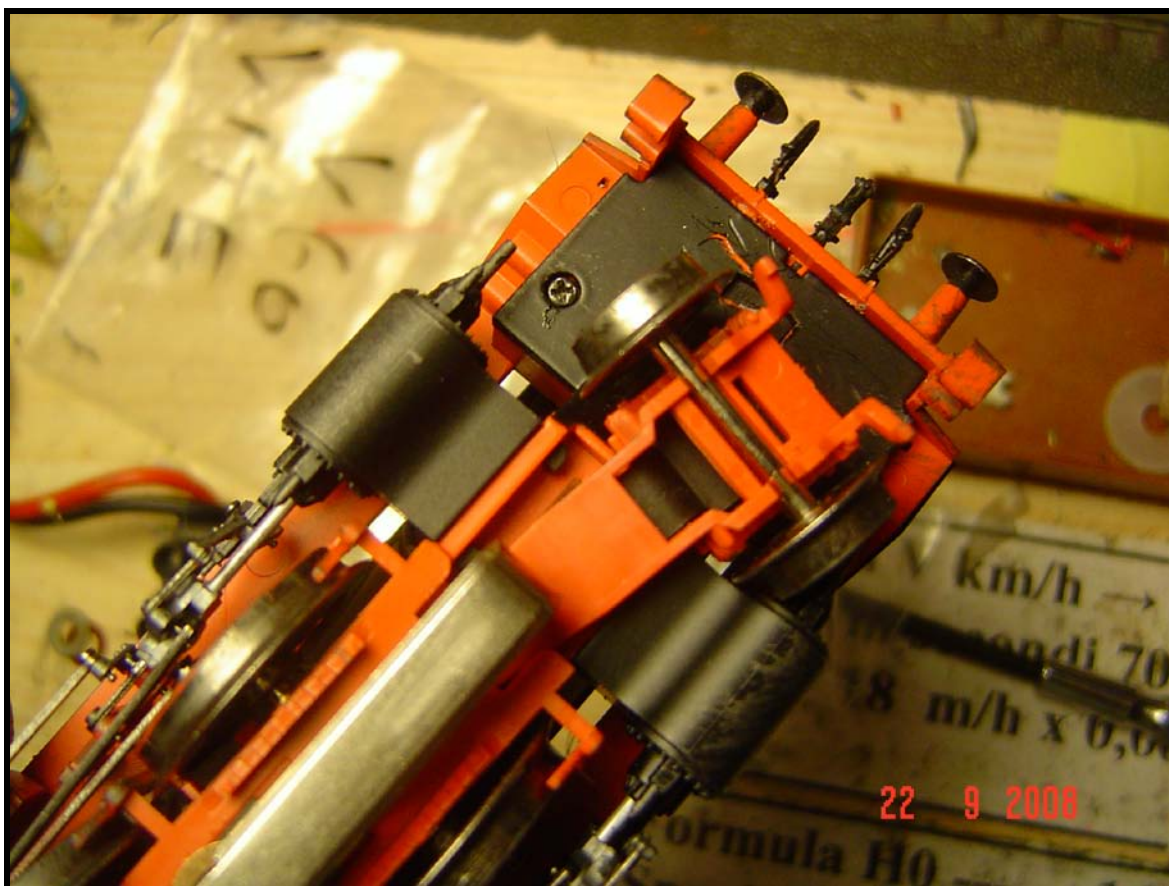
Una delle 2 UNICHE VITI da svitare, l'altra è nascosta dal carrello portante!
