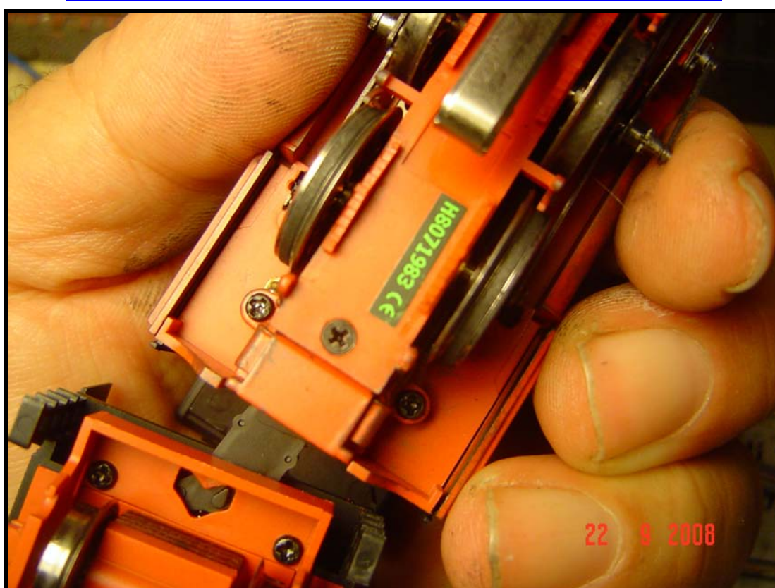
NON SVITATE assolutamente le 3 viti vicine al tender, trasmettono anche il contatto
