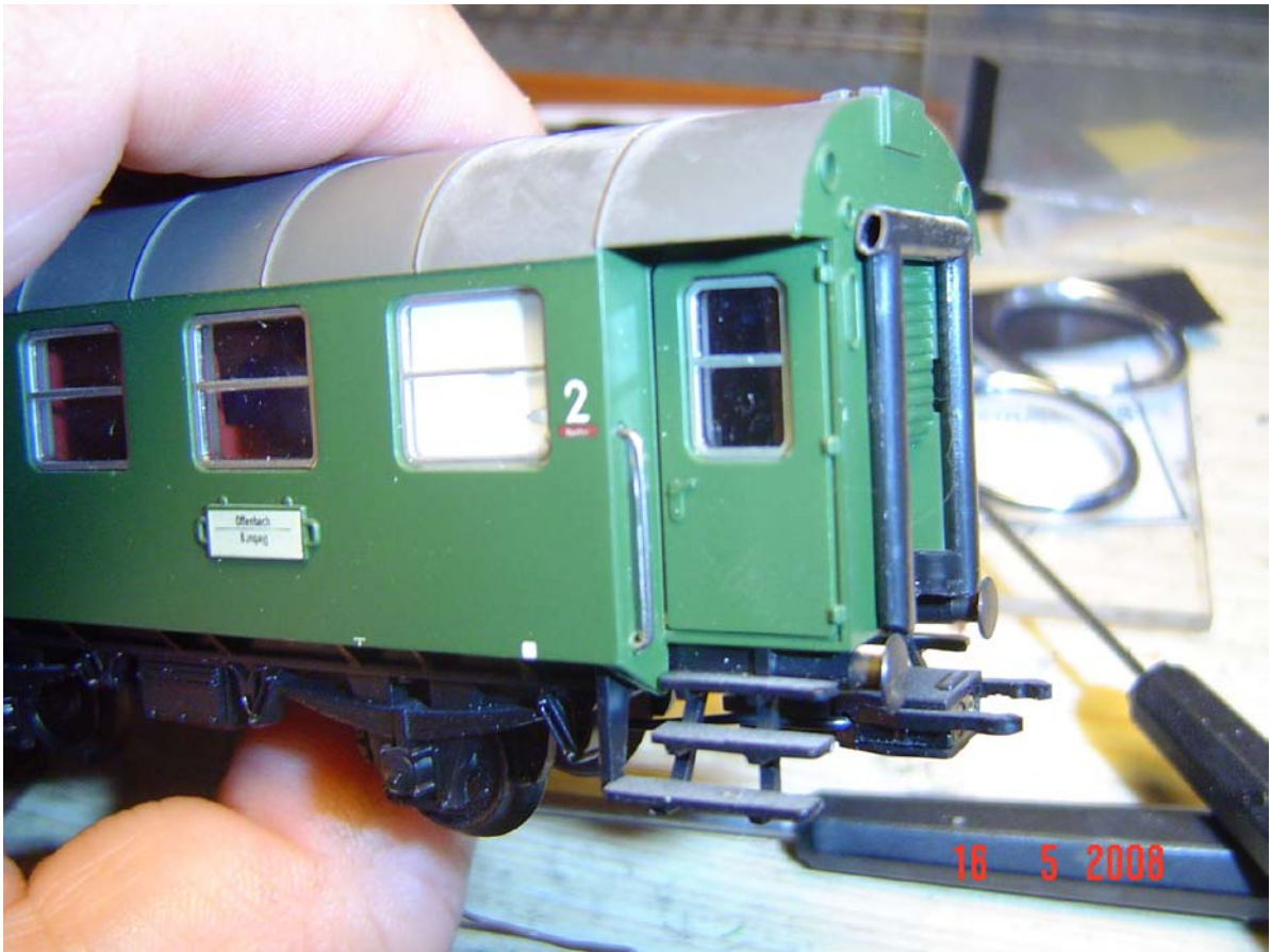
Il corrimano va spostato leggermente in fuori (foto n. 39)
